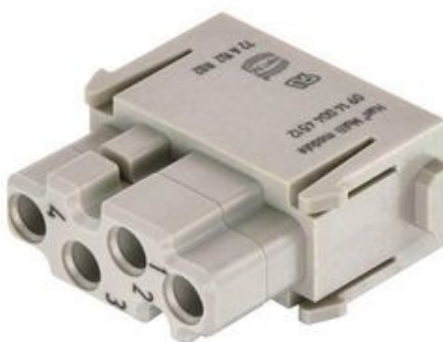
09140044513 HDC; modul; vidlice; PIN: 4; 50V; 500cyklů; UL94V-0
